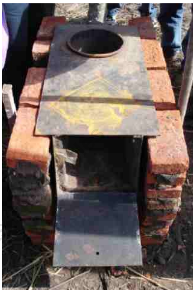
La cocina puede ir sobre patas de hierro o sobre ladrillos
